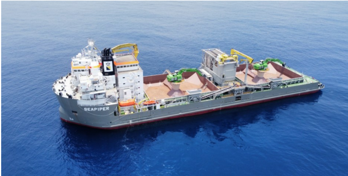
Figur 3.8 Et skib, som vil levere stenmateriale for at styrke jorden før fundamentarbejde påbegyndes (Kilde: https://www.portalmorski.pl/zegluga/53382-nowy-podsypkowiec-boskalisa )
