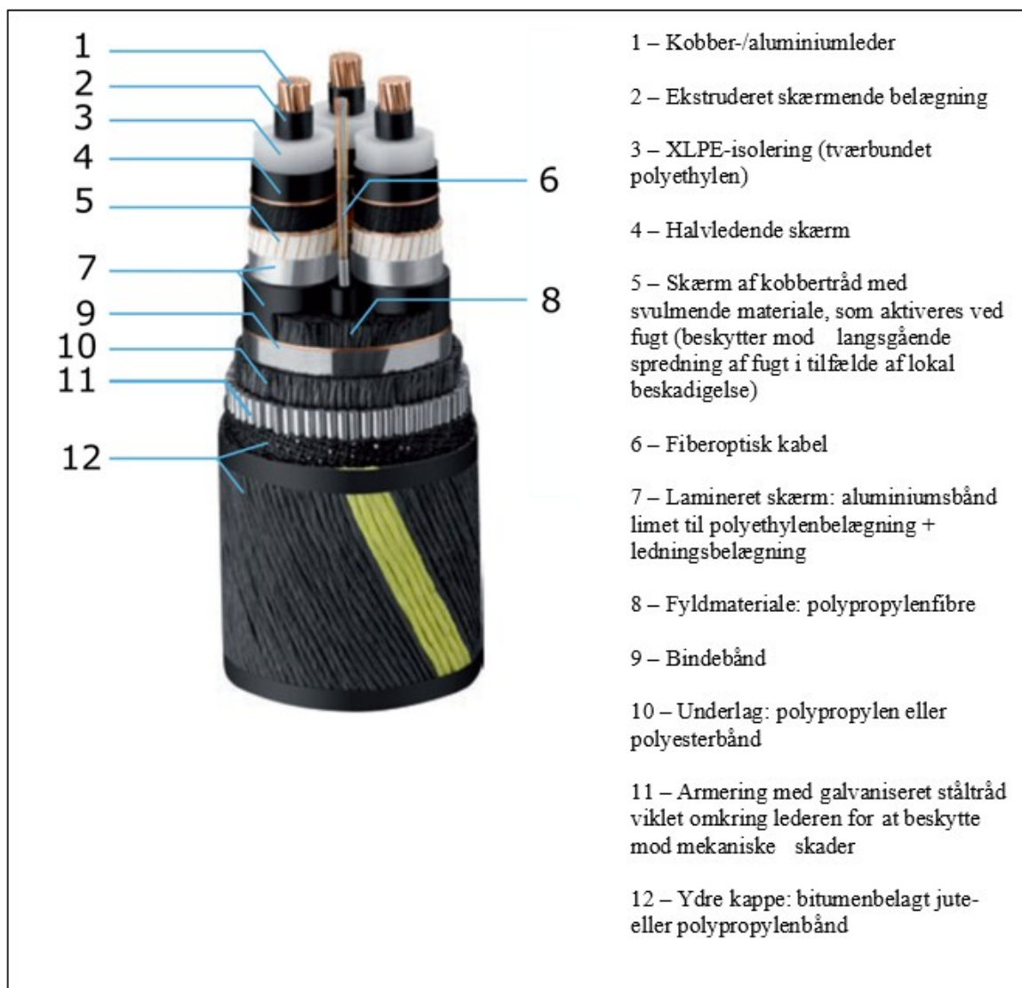
Figur 3.5 Eksempel af et højspændingssøkabel (kilde: egne materialer baseret på: nexans.com)
